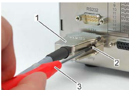
Abb. 27: Befestigungsschrauben festdrehen (Rückseite)
